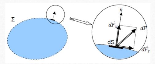
$d\vec{f}$ : la force d'interaction au niveau de la surface élémentaire dS de normale  $\vec{n}$  entre le fluide et le milieu extérieur. On Décompose  $d\vec{f}$  en deux composantes:  $d\vec{f}$ N et  $d\vec{f}$ T.
